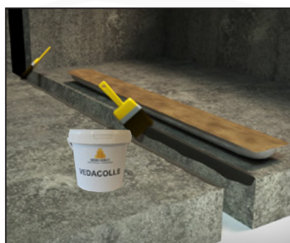
Encoller les deux côtés du joint ainsi qu'une bande de 5 cm sur la partie supérieure du béton.
