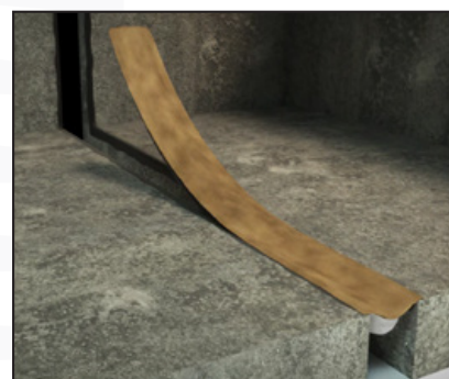
Insérer la nappe dans le joint.
