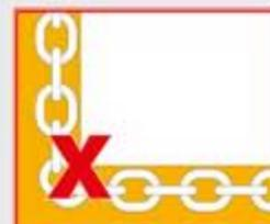
■ Protéger contre les angles vifs, les arêtes, les appuis de diamètre inférieur au diamètre du fil de la chaîne. Utiliser des garnitures de protection. Ne jamais travailler avec des chaînes travaillant sur des angles vifs.
