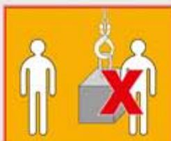
■ Les opérateurs doivent être suffisamment éloignés de l'élingue lors de la mise sous tension des brins. Lors du levage, personne ne doit se trouver dans la zone du danger, et à plus forte raison monter sur la charge ou passer sous elle.
