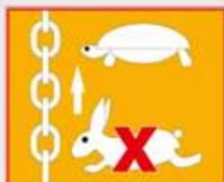
■ Éviter les chocs et les à-coups au levage. La tension de l'élingue doit se faire progressivement, et le levage sans accélérations ou manœuvres brusques.
