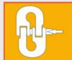
**Mailles d'assemblage et autres systèmes de liaison :** vérifier le bon positionnement de leurs éléments constitutifs (demi-maillons, axe, système de verrouillage, bague ou goupille). Vérifier le verrouillage correct de ces éléments.
