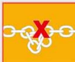
■ Éventuellement, les brins doivent être réglés par des crochets raccourcisseurs. Ne jamais allonger ou raccourcir un brin par un nœud ou un boulon. Jamais de chocs pour rectifier le positionnement des brins ou des crochets.
