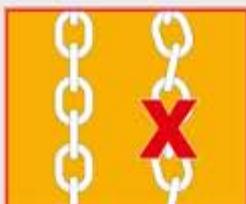
■ Centrer le crochet de levage. L'élingue doit être disposée sans torsion ni nœud. Ne jamais soulever avec une chaîne vrillée.
