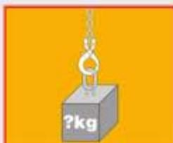
■ Avant toute opération, la masse à soulever doit être déterminée, et l'élingue choisie en conséquence et en fonction de l'angle d'élingage. S'assurer que la charge n'est pas fixée ou ancrée.
