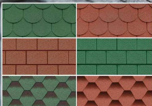
Les bardeaux bitumineux sont des matériaux de revêtement de toiture composés d'un mélange de bitume, de granulats minéraux et de fibres de verre ou de feutre. Le bitume est un matériau pétrolier visqueux qui agit comme une colle pour maintenir les granulats minéraux en place sur le toit. Les granulats minéraux sont souvent de la pierre concassée ou du sable qui sont mélangés avec le bitume pour créer une surface texturée et résistante.
